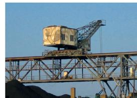
den Nordring hinweg in einen Kohlebunker der Energieversorgung Offenbach (EVO). Dabei rangiert er mit einer Geschwindigkeit von 15 km/h auf einer 53 m langen Ladebrücke. Doch
