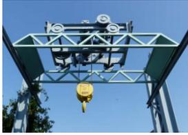
Eine Laufkatze ist ein Hebe- und Transportgerät, das in Produktionsstätten eingesetzt wird, um schwere Lasten von oben punktgenau an einer bestimmten Stelle abzusetzen. Dabei läuft der
